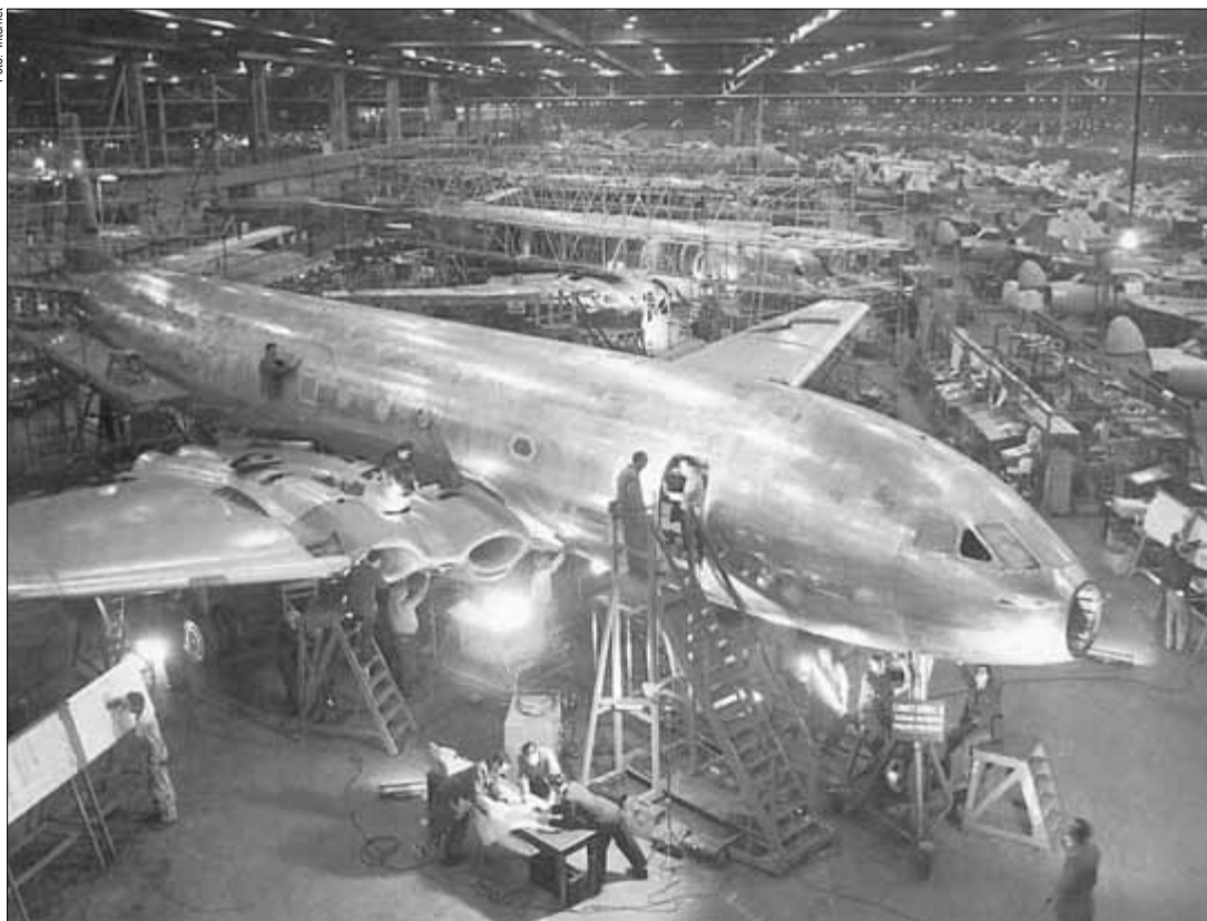
Im März 1957 steht die einstige UAT-Maschine cn 06045 im selben Bauzustand im Chester-Werk wie im April 1954 da, diesmal aber mit ovalen Fenstern, verstärkter Haut und nach außen gefeiltten Schubdüsen als Comet 2C.
