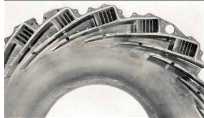
Leichtmetall-Impeller und Turbinenscheibe stecken auf einer gemeinsamen Welle.
