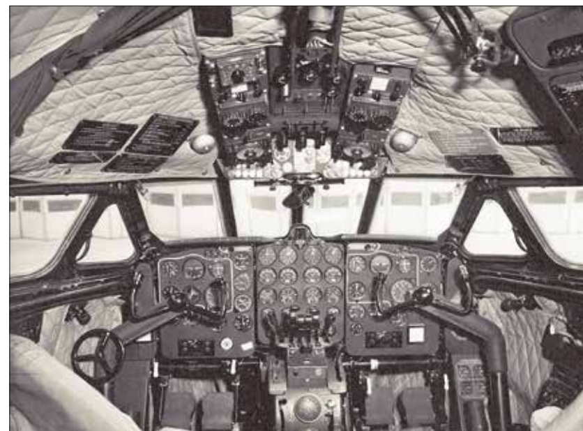
Die erste Comet 1A, CF-CUM, für die Canadian Pacific Airlines bei der Flugvorführung in Farnborough vom 1. bis 7. September 1952, fotografiert von einem Reporter des Aeroplane Magazins. Bei dem Foto sieht man, welche Aufgabe die beiden Schnüre an den Mittelfenstern hatten, nämlich die Scheiben von Regentropfen zu befreien.
