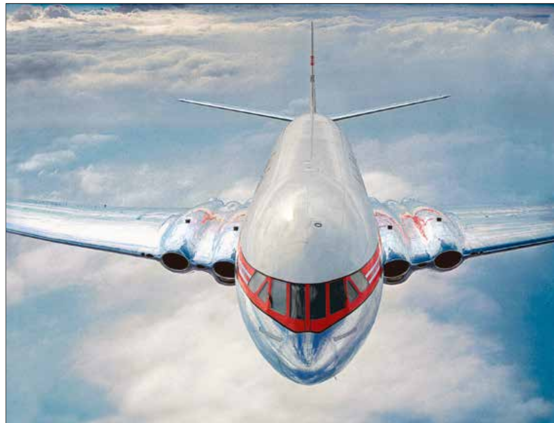
Die erste Comet 1A, CF-CUM, für die Canadian Pacific Airlines bei der Flugvorführung in Farnborough vom 1. bis 7. September 1952, fotografiert von einem Reporter des Aeroplane Magazins. Bei dem Foto sieht man, welche Aufgabe die beiden Schnüre an den Mittelfenstern hatten, nämlich die Scheiben von Regentropfen zu befreien.
