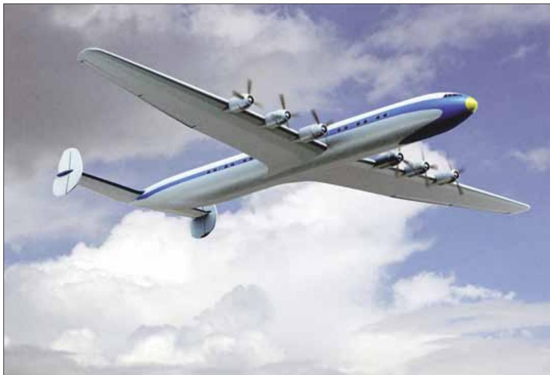
**Die JU/EF-100 mutet wie ein Turboprop-Riese aus den 60er Jahren an. Der dünne Flügel mit extrem hoher Streckung basiert auf dem der JU/EF-61 und sorgt für große Flughöhen und große Reichweite. Die Dieselmotoren mit Turbolader bilden jedoch den Grundstock für das gesamte Projekt. Denn nur mit ihnen konnten die projektierte Flughöhe und -geschwindigkeit erzielt werden. Eine Militärversion gab es auch.**
