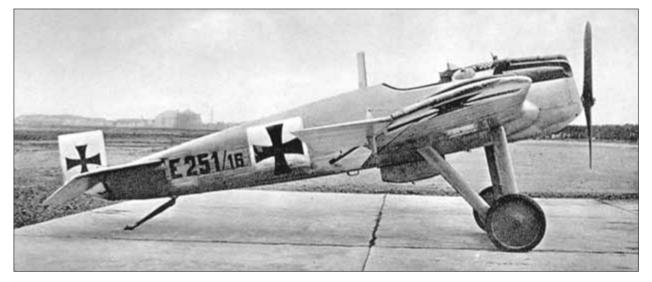
Bereits die J.2 basierte auf dem von Hugo Junkers angemeldeten Tiefdecker-Patent. nach dem heute alle modernen Verkehrsflugzeuge gebaut werden. Der Vorteil der Tiefdeckeranordnung besteht im geringeren Gewicht der Gesamtmaschine, da die auf den Flügel aufbauenden Bauteile sich zugleich auf diesen abstützen können. Desweiteren bietet der Tiefdecker bei Bruchlandungen wesentlich besseren Schutz für die Besatzung.
