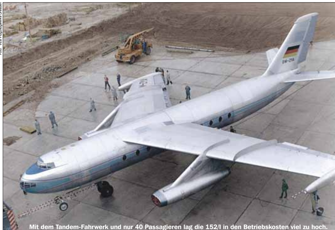
Mit dem Tandem-Fahrwerk und nur 40 Passagieren lag die 152/I in den Betriebskosten viel zu hoch.
