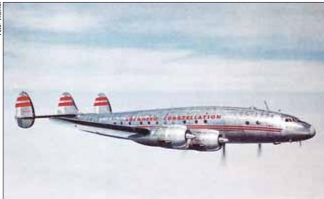
**Dieses Bild vom fliegenden Prototypen zeigt eindrucksvoll das stark gewölbte Rumpfprofil der L-049 mit 40 % f/l bei nur 30 % d/l. Der**
