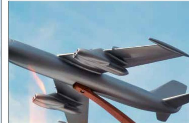
hängend auf. Diese Lösung hatte zuerst konstruktive Vorteile gegenüber Einzelaufhängung (Gewichtseinsparung), allerdings entsprach sie nicht der Flächenregel, doch die entdeckten die Amerikaner ja erst fünf Jahre später (1952). Dafür aber konnten die Boeing-Ingenieure das
