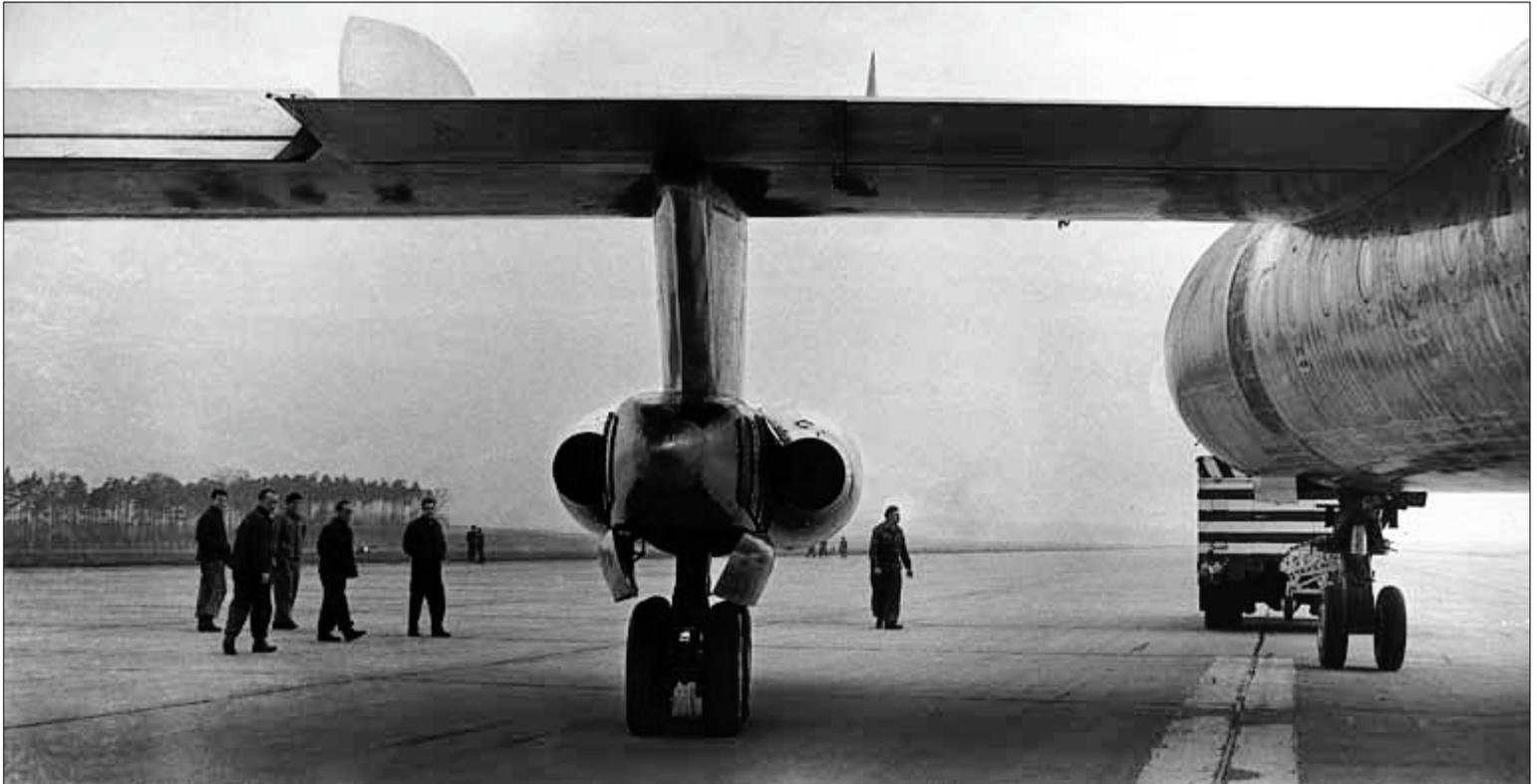
**B**ereits im Februar 1960 wurden mit einer IL-14 Rollversuche mit dem neuen Fahrwerk unternommen. Vom 25. bis 29. April 1960 erfolgte dann mit der V4 ein umfangreiches Rollen, wo das Rollverhalten des Fahrwerkes, die Ermittlung der zweckmäßigsten Bremsdrücke und der maximalen Bremswege auf dem Programm standen.
