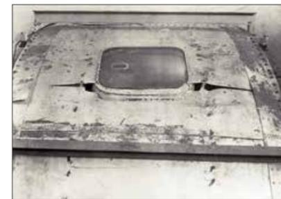
Vorversuchsstück zur Erprobung von Fenster und Fensterrahmen in einer Teilrumpfschale. Der Riß ging, wie später bei der RAE festgestellt, von den Fensterecken aus und quer über die Hilfsspannen hinweg längs des Rumpfes. Dieses wie andere Probleme waren also bekannt!
