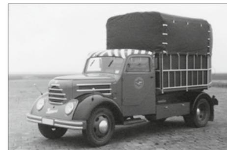
Auf dem Fahrgestell des 1,5-Tonnens Garant aus Zittau bauten die Schkeuditzer diesen mit Hilfe eines Scherengitters hochfahrenden Gepäck- und Montagecontainer auf. Um eine Straßenzulassung mußte sich Schkeuditz auch kümmern. Der Garant war neben dem H3A aus Werdau ein beliebter Transporter, allerdings mit Otto-Motor.
