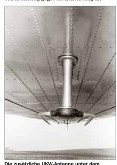
Rumnf versorgte die handelsübliche RFT-Rundfunkempfangsanlage "Undine II" mit Signalen. Das Wechselstrom-Bordnetz versorgte das Radioempfangsgerät.
