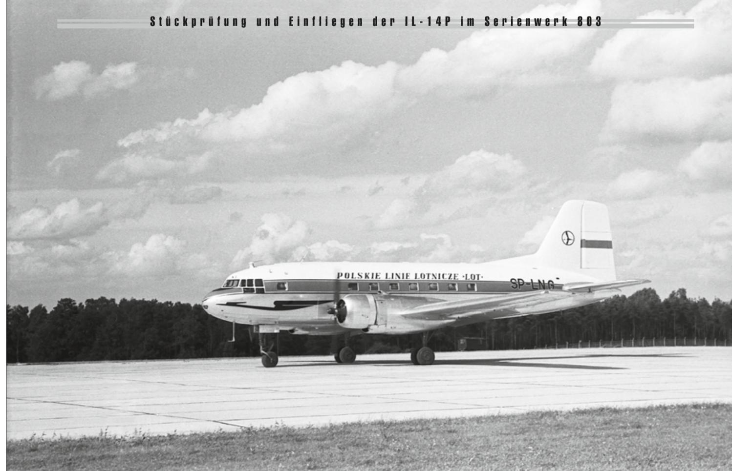
des Ladedrucks erfolgt, Feststellen der Druckhöhe (Höhenmesser auf 760 Torr) beim Abfallen des Ladedrucks und des Unterschieds zwischen beiden Motoren, Messung der Außentemperatur; Beurteilung der Kühlleistung anhand der serienmäßig eingebauten Überwachungsgeräte; 6.) Wechselseitiges Abstellen beider Motoren zur Prüfung der Segelstellungsautomaten beider Luftschrauben. FT-Flug: Prüfung auf Funktion und Leistung von 7.) Funktechnischer Anlage für Streckenflug (Reichweite, Stör-
