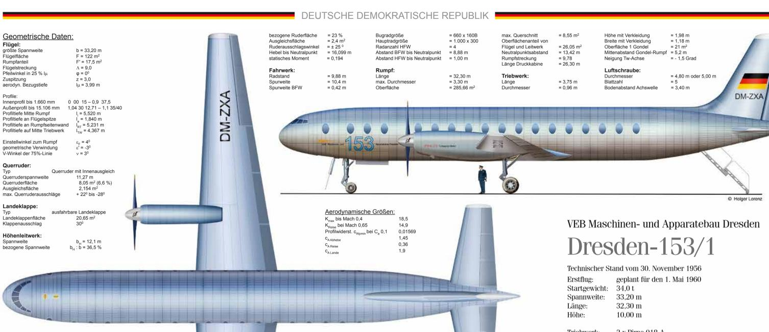
Höhenleitwerksfläche  $F_{..} = 30.5 \text{ m}^2$ bezogene HLW-Fläche F., : F = 25 % Rumpfanteil am HLW  $= 4.02 \text{ m}^2$ Streckung HLW Pfeilwinkel der 25%-Linie  $\varphi_{\sqcup} = 8 \text{ Grad}$ Zuspitzuna = 2.0 $I\mu_{H} = 2,62 \text{ m}$ aerodyn. Bezugstief
